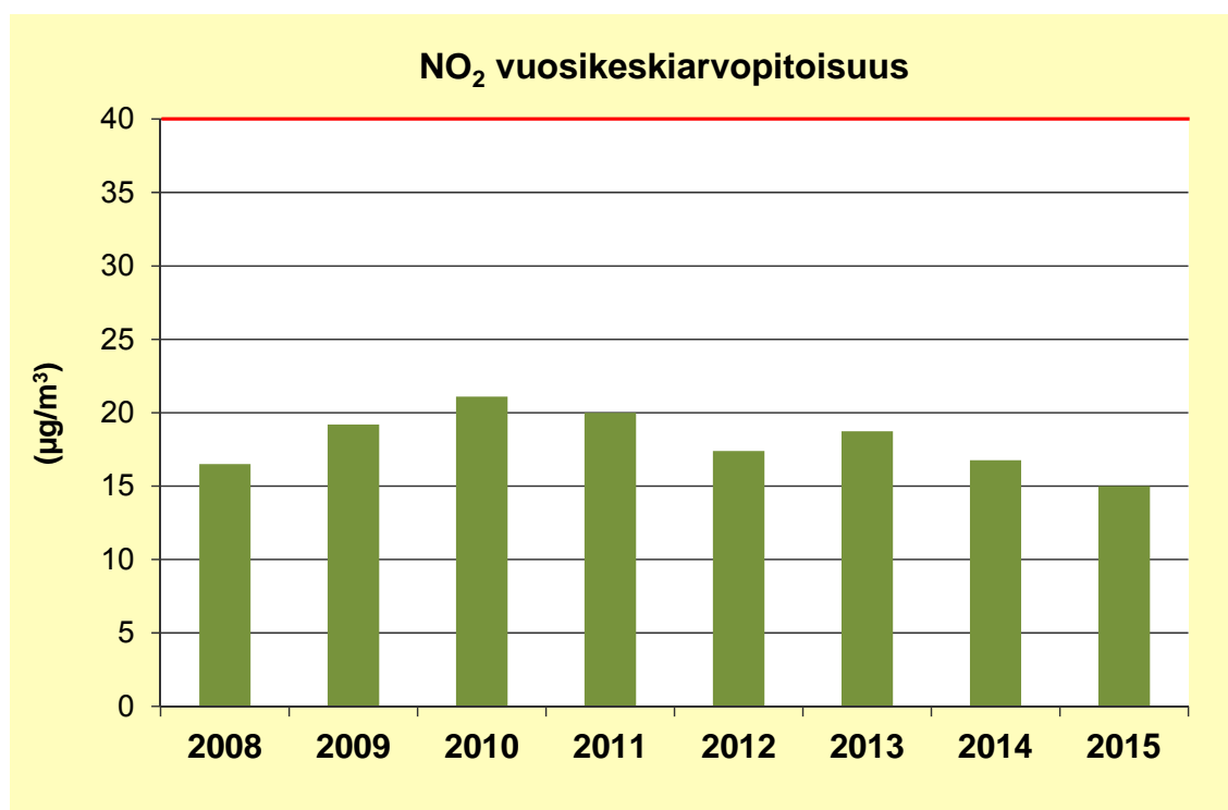
Kuva 6.8. Typpidioksidipitoisuuden vuosikeskiarvot Kajaanin keskustassa vuosina 2008–2015). Raja-arvotaso, 40 \mu\text{g}/\text{m}^3 , on merkitty kuvaan punaisella vaakaviivalla.
