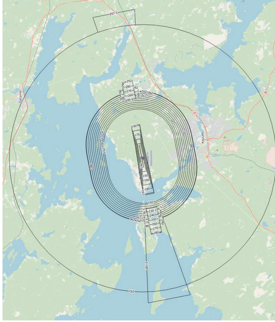
Kuva 32. Lentoesterajoituspintojen alueet Paltaniemen lentoaseman ympärillä. Esteipinnat määrittävät tason, joka sekä kiinteiden, että väliaikaisien rakenteiden ja laitteiden tulee alittaa. Esteipintojen alittuussakin tulee hakea lentoestelupaa ilmailulain 158 § mukaisesti. (Lentoesterajoituspinnat: Finavia, 2019)
