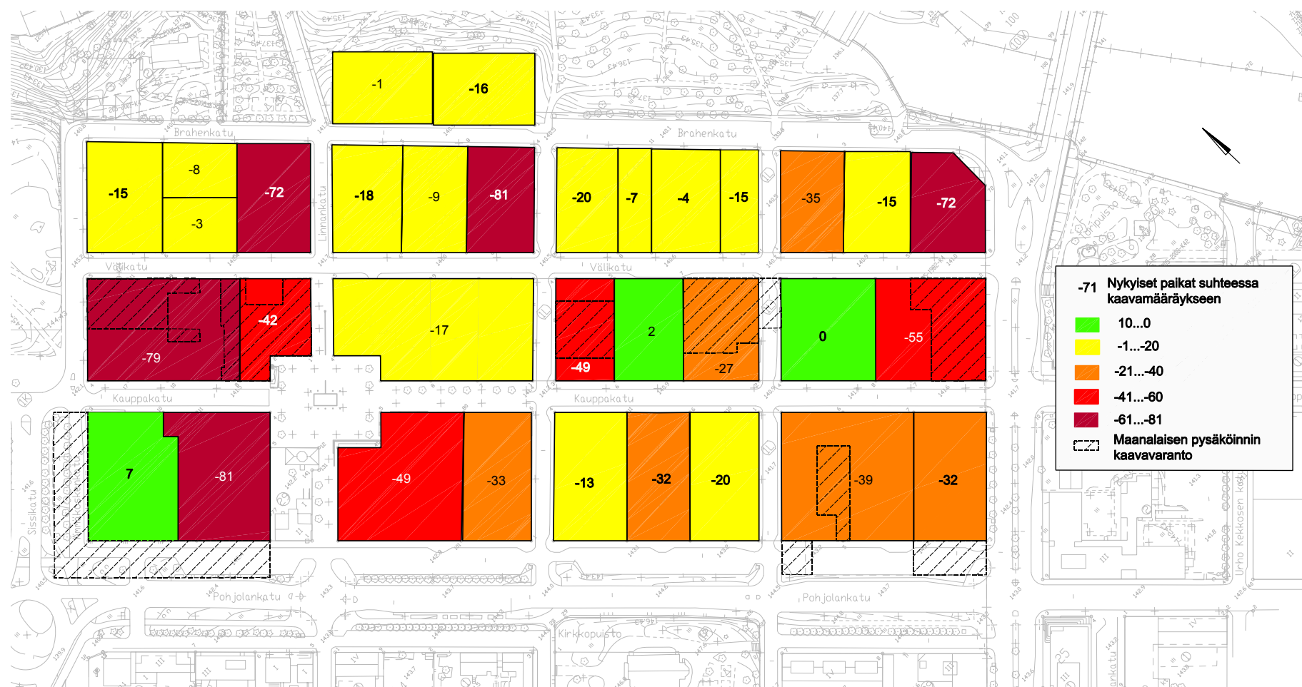
Kuva 26: Keskustan asemakaavan mukaisten autopai-kojen määrysten suhde tonteilla olemassa oleviin autopai-koihin sekä maanalaisen pysäköinnin kaavavaranto.
